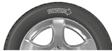
Beispiel einer Kennzeichnung der Laufrichtung
